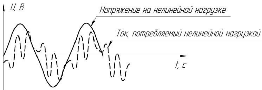
Рис. 1. Форма напряжения, поданного на нелинейную нагрузку, и потребляемого ей тока
