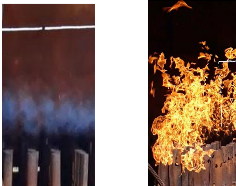
Рис. 4. Горение газов 1-й и 2-й ступеней
