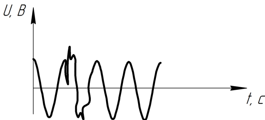
Рис. 2. Искажения сетевого напряжения при переходных процессах
